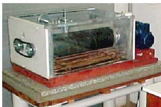
Figura 4: a) Abrasômetro DIN 53.516. b) Gráfico da perda de volume para as amostras testadas.
