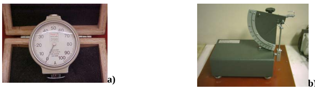
Figura 3: a) Durômetro Shore A, b) Resiliômetro Maq test
