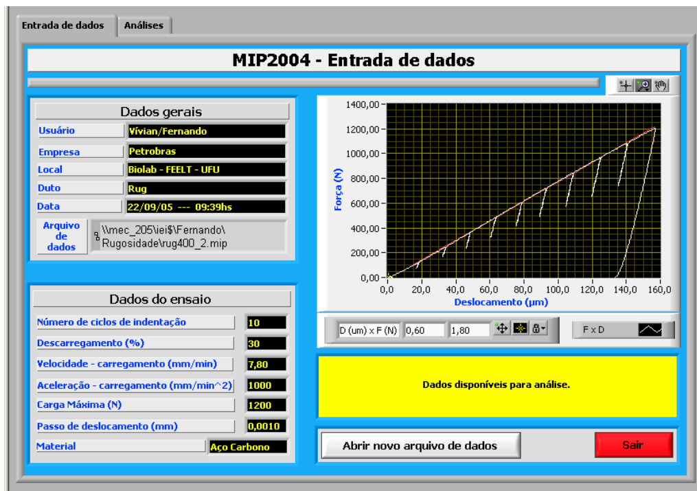
Figura 3: Parâmetros usados no ensaio de macroindentação instrumentada: (a) programa de supervisão de ensaio, (b) programa de cálculo das propriedades mecânicas.
