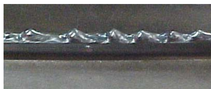
Solda em não conformidade (junta em aresta)
