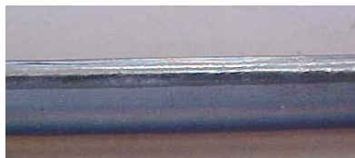
Solda conforme (junta em aresta)
