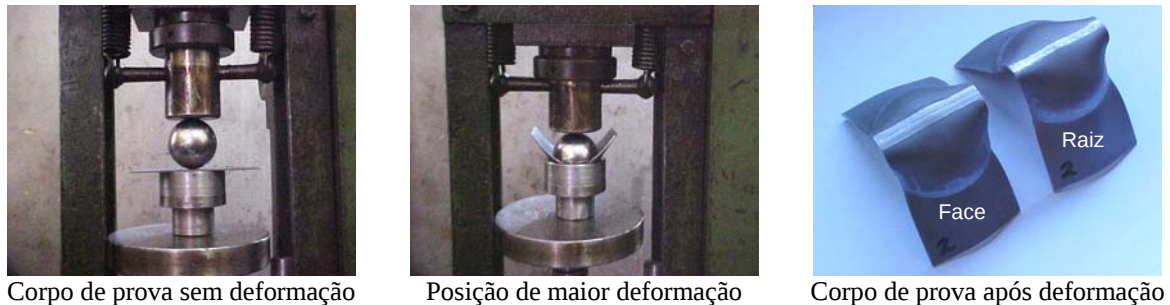
Figura 14: Execução do teste de estampabilidade e corpos de prova deformado
