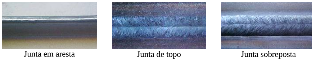
Figura 7: Aspecto típico dos cordões obtidos nas velocidades limites de soldagem
