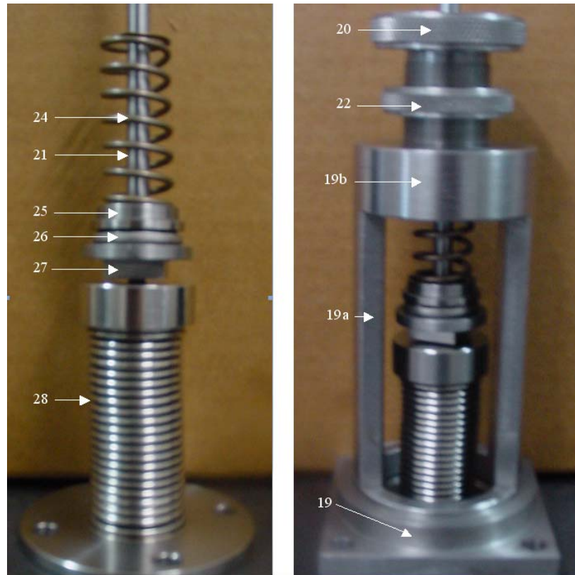
Figura 1.5: Montagens preliminares dos suportes dos foles.
