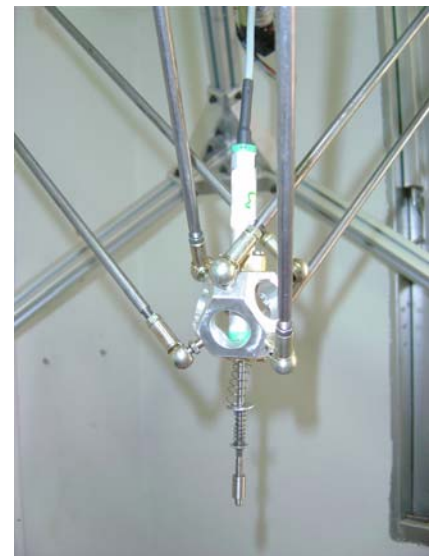
(b) Detalhe da plataforma móvel com um transdutor linear.
