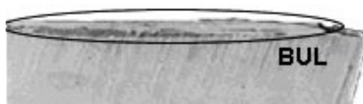
Figura 4: BUL aderida no desgaste de cratera (Qi et al.1989 apud Qi; Mills, 2003)
