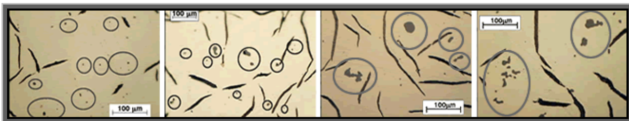
Figura 4: Morfologia das inclusões de sulfeto de manganês no ferro fundido cinzento com 0,065%, 0,12%, 0,15% e 0,18% de enxofre.
