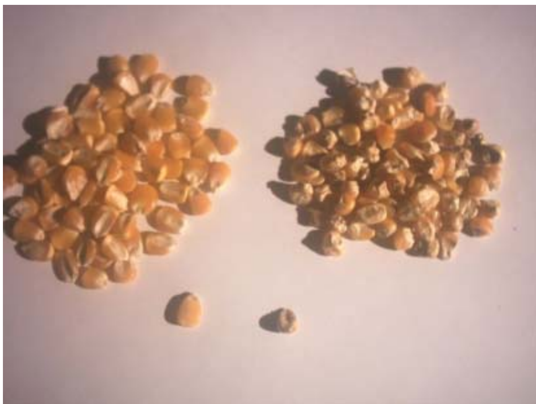
Figura 4: Amostra de Grãos Sadios (esquerda) e Amostra de 14% em Peso de Grãos Ardidos (direita)
