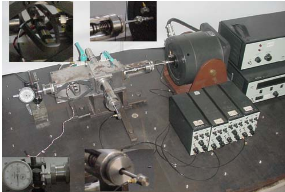
Figura 6: Bancada Experimental do amortecedor ativo com o shaker acoplado.
