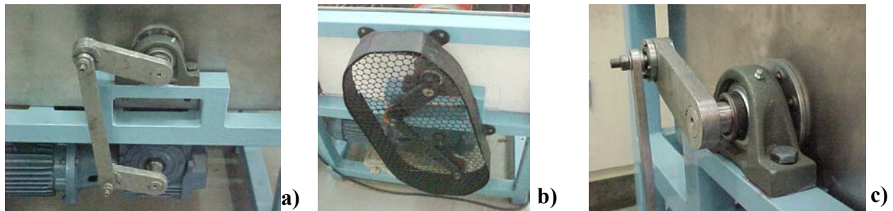
Figura 9: Vista mostrando motor de acionamento do cilindro porta-amostra.
