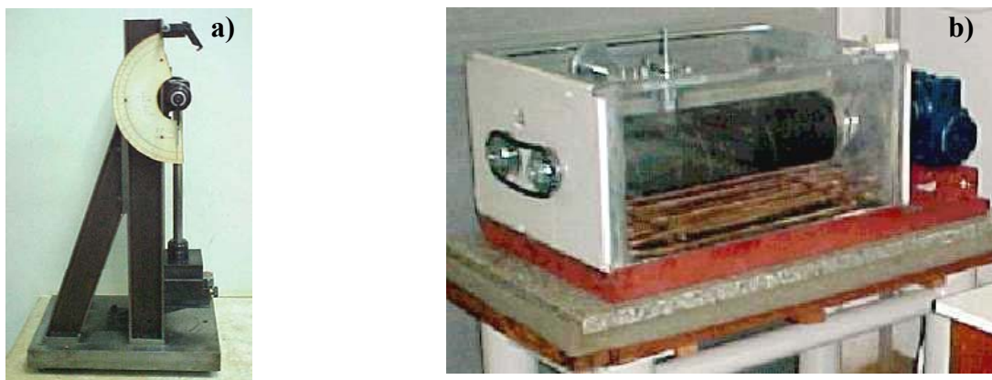
Figura 3: Equipamentos utilizados atualmente para avaliação do desgaste abrasivo em linhas flexíveis: a) Esclerômetro pendular e b) Abrasômetro DIN 53.516
