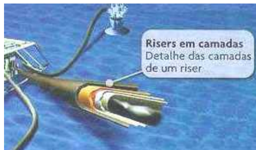
Figura 1: Detalhe da armação de um riser. Fonte: Veja-Petrobras/Edição 2002.
