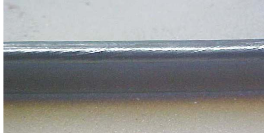
Figura 8: Acabamento do cordão na velocidade limite de soldagem com o uso da mistura Ar + 5%X
