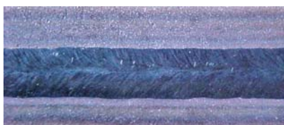
Solda em conformidade, junta sobreposta
