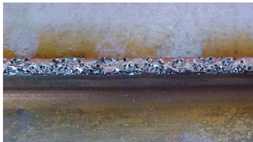
Figura 10: Porosidade no cordão de solda realizado com a mistura de Ar + 5%Y
