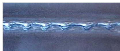
Solda em não conformidade, junta sobreposta
