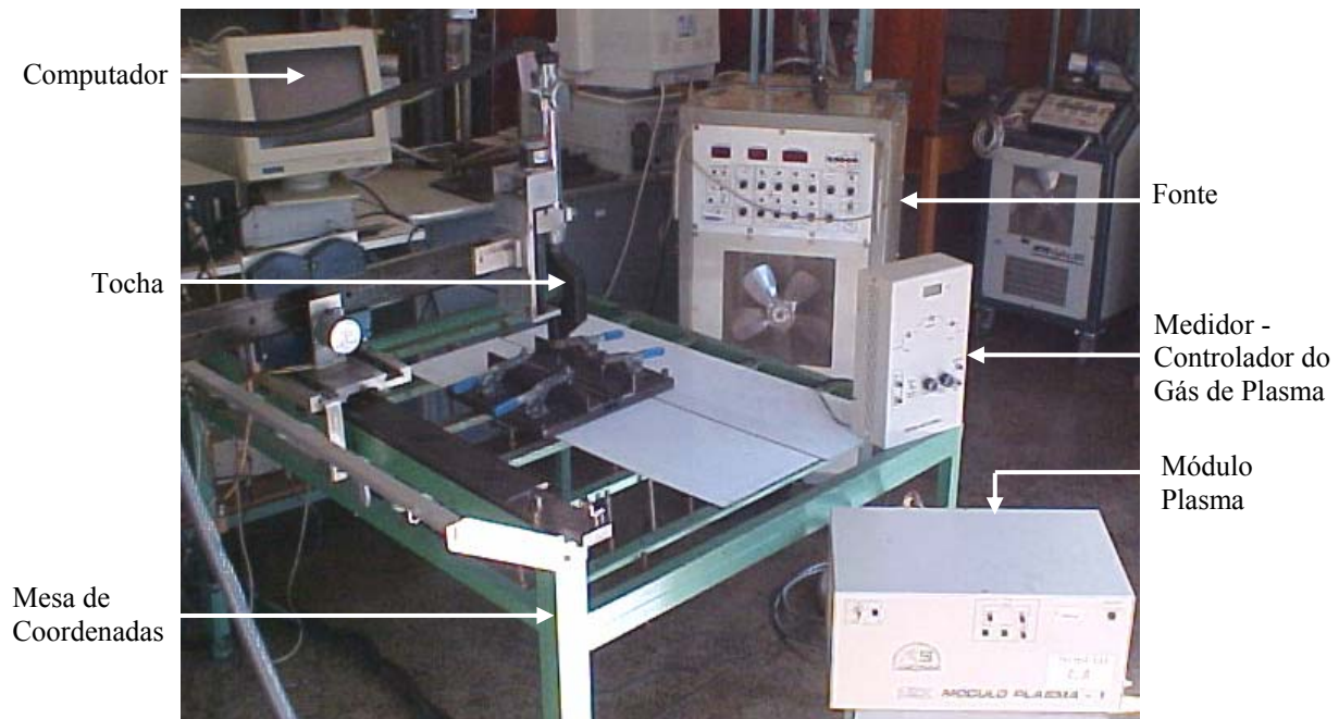
Figura 4 : Equipamentos utilizados no sistema de soldagem
