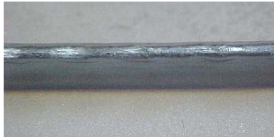
Figura 6: Aspecto do cordão de solda na velocidade de soldagem máxima utilizando Ar
