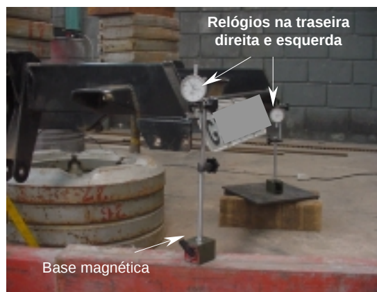
Figura 7: Relógios instalados na traseira
