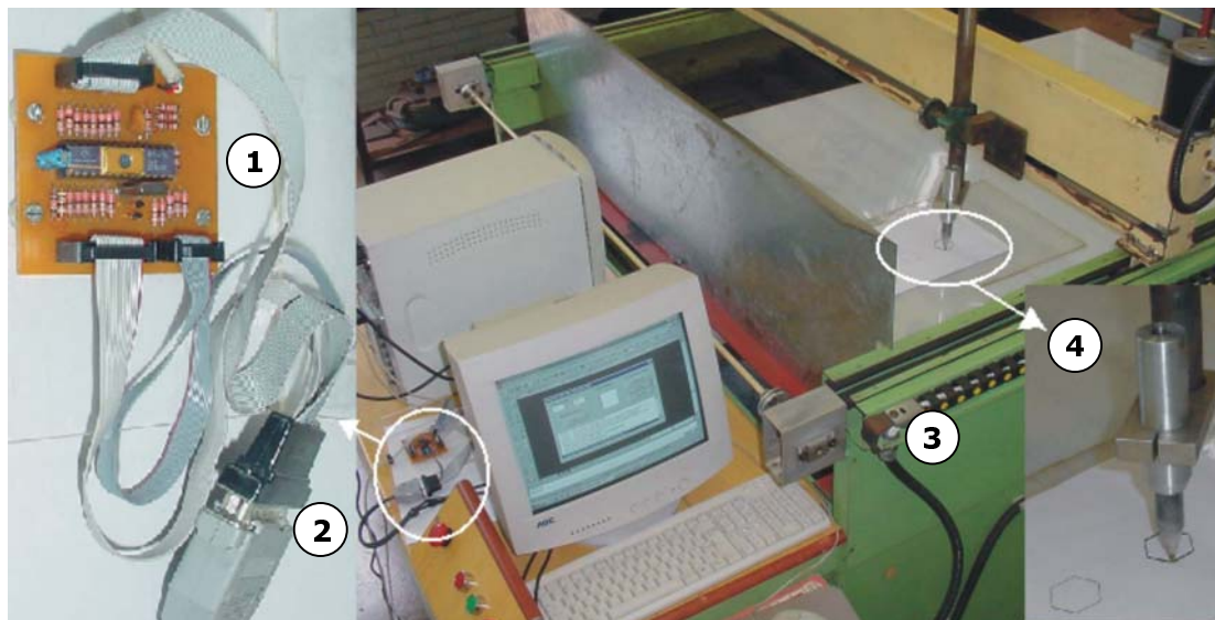
(1) Placa USB-HID/PIC; (2) Conector do dispositivo de acionamento dos motores de passo; (3) Mesa de coordenadas X-Y e (4) Dispositivo de fixação da caneta esferográfica.
