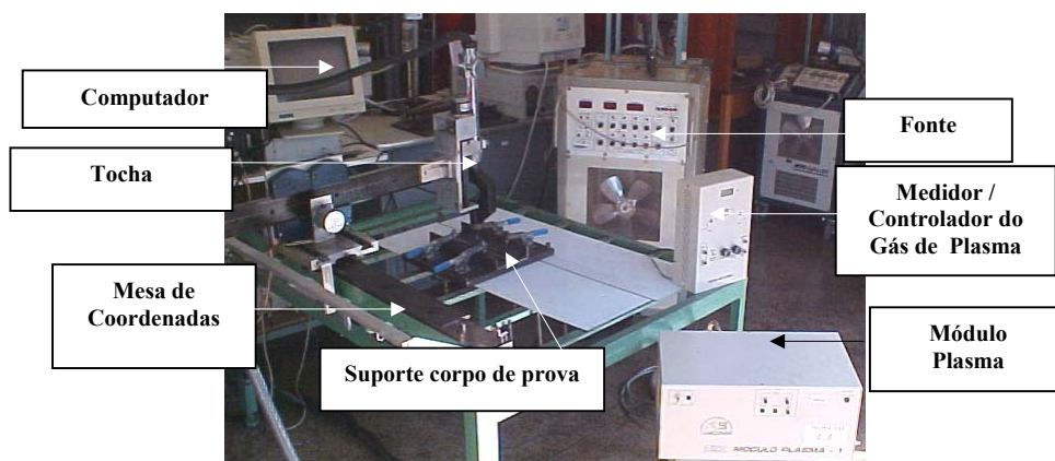
Figura 2 : Equipamentos utilizados no dispositivo para soldagem.
