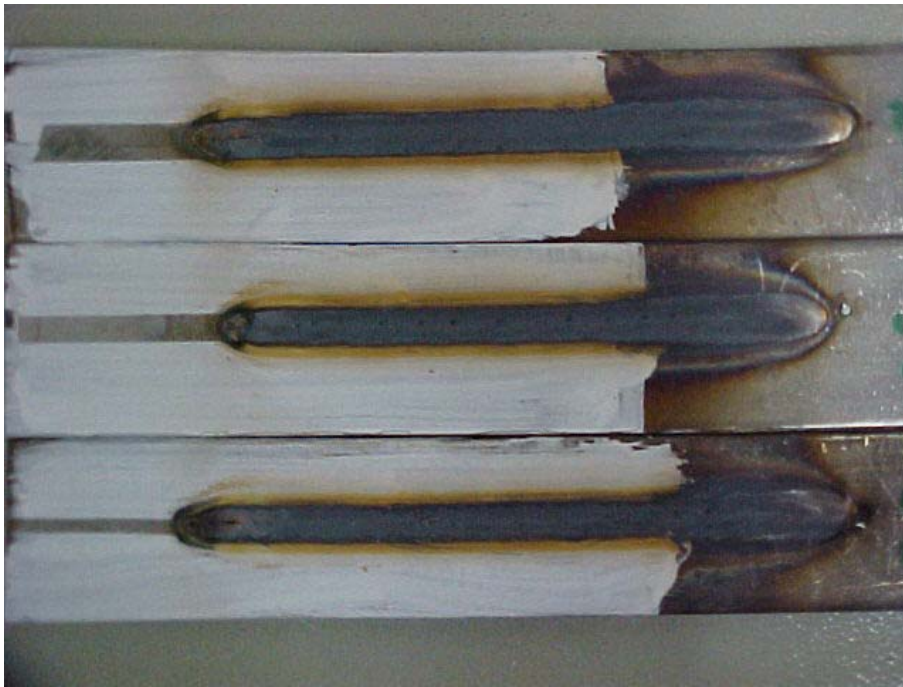
Figura 5: Testes realizados na soldagem com keyhole usando aberturas de 8, 5 e 3 mm (de cima para baixo, respectivamente) para o caminho preparado de fluxo.
