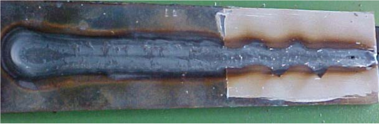
Figura 9: Teste com keyhole realizado em trajetória de fluxo em zig-zag.
