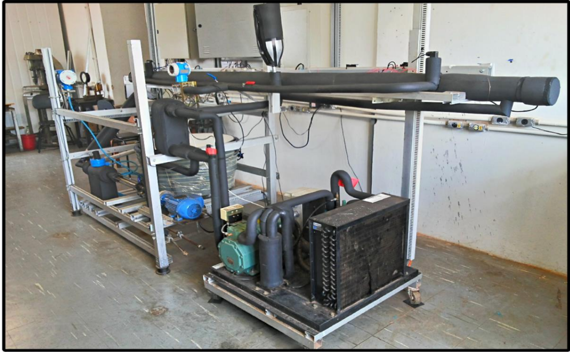
Figura 3. Equipamento experimental para avaliar o desempenho termohidráulico dos nanofluidos.
