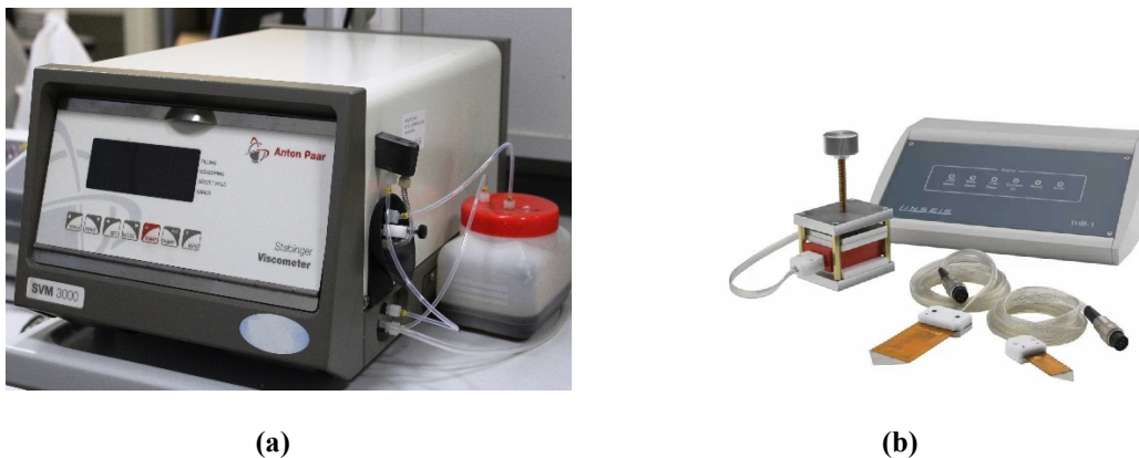
Figura 2. Equipamento de medição (a) viscosímetro SVM3000 de Anton Paar, (b) Medidor de condutividade térmica THB1 Linseis
