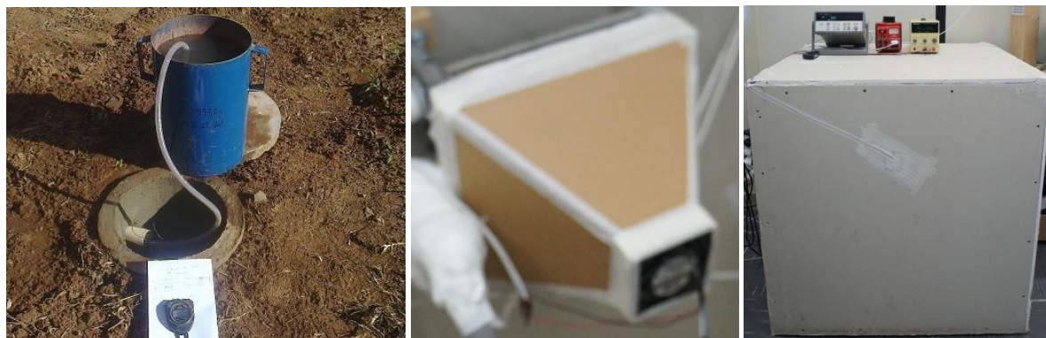
Figura 3. Da esquerda para a direita: o Reservatório, o fan coil e o ambiente climatizado
