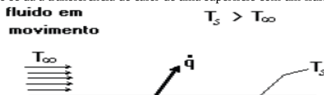
Figura 2 - Diagrama de transferência de calor entre uma superfície e um fluido em movimento.
