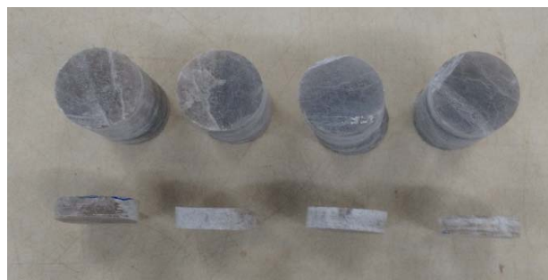
Figura 2. Amostras utilizadas para a realização dos ensaios de resistência à compressão simples (amostras grandes) e diametral (amostras pequenas).
