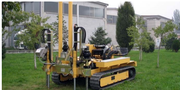
Figura 3. Equipamento para ensaio CPT
