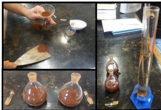
Figura 1. Ensaio de peso específico real dos grãos
