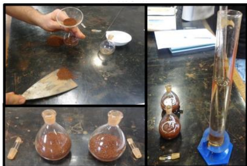
Figura 1. Ensaio de peso específico real dos grãos
