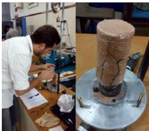
Figura 1. Preparação e ensaio de compressão simples
