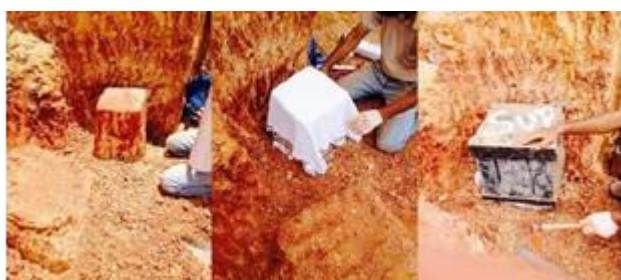
Figura 2. Coleta de amostra no município de Camaragibe: a) escavação do bloco indeformado, b) Cobertura do bloco com papel filme, papel alumínio, tecido de algodão e c) armazenamento do bloco para transporte.
