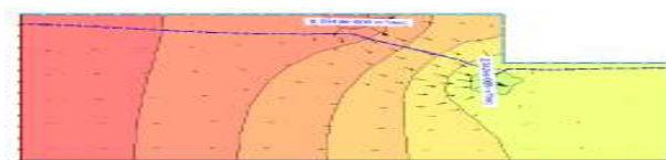
Figura 9. Simulação para poço de recarga.
