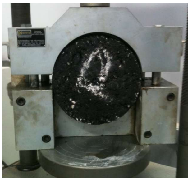
Figura 2. Aparato para realização dos ensaios de cisalhamento de interface.
