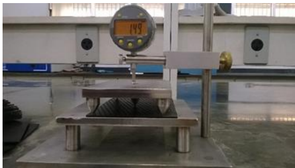
Figura 5. Ensaio de Espessura da Geomembrana Texturizada.
