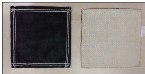
Figura 4. Geotêxtil de dupla camada (à esquerda) e Geotêxtil de camada simples (à direita). Fonte: Caressato, W. (2015).
