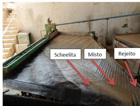
Figura 3. Beneficiamento da Scheelita. Fonte: Mina Brejuí (2016)
