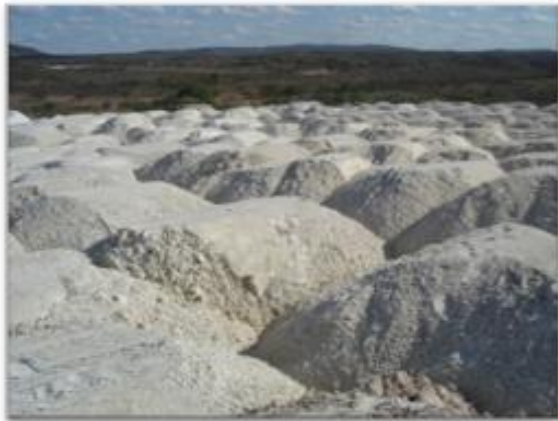
Figura 4. Aterro de resíduo do beneficiamento de caulim - Equador/RN Fonte: Costa, C. G. (2006)
