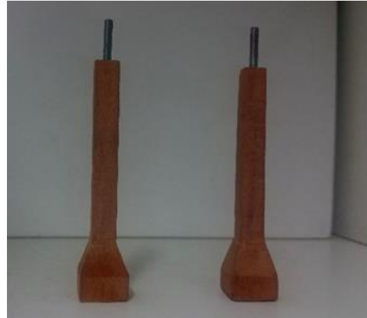
Figura 5 - Sapatas quadradas de 5 mm de aresta utilizadas nos ensaios. Fonte: Autores.
