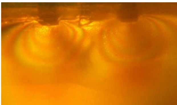
Figuras 11 - Interação entre os bulbos a 49mm de distância. Fonte: Autores.
