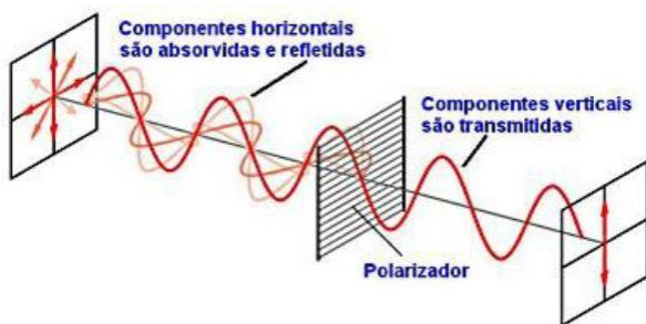
Figura 1 - Polarização da luz branca (modificado de Schiavon, 2010)
