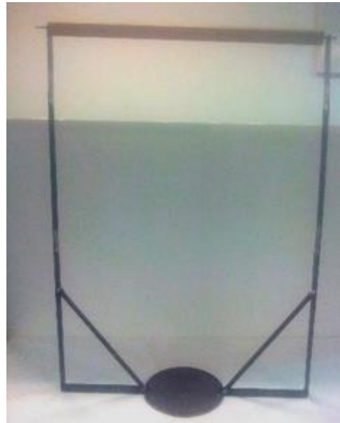
Figura 8 – Sistema de aplicação de carga (Autores).
