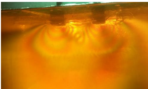
Figuras 10 - Interação entre os bulbos de tensões dos modelos de sapatas de 5 mm a 29mm de distância.
