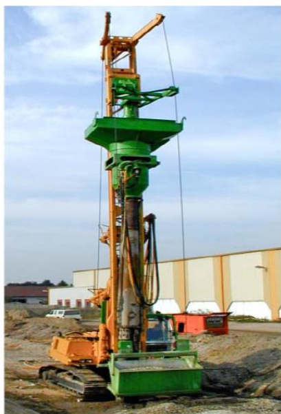
Figura 3. O uso de equipamentos e tecnologias para execução de colunas de pedra a partir da base (DE ALMEIDA, 2014)
