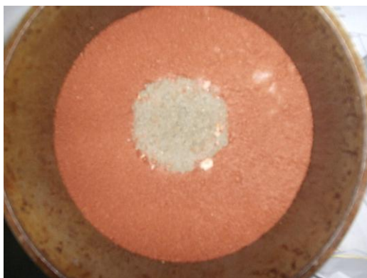
Figura 3: Resultado final das perfurações preenchidas em camadas por argamassa.
