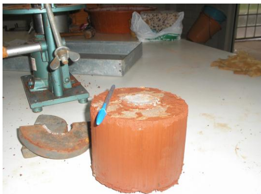
Figura 6: Detalhe da amostra após o rompimento da estaca.
