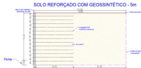
Figura 5. Corte transversal do solo reforçado com geossintético, 5 m.
