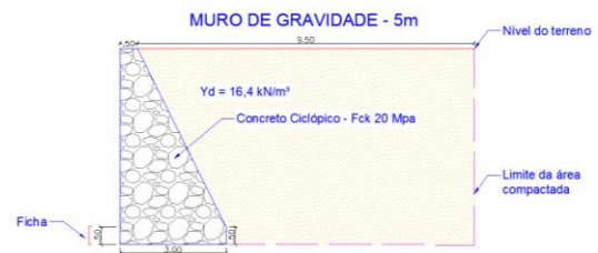
Figura 1. Corte transversal do muro de gravidade, 5 m.
