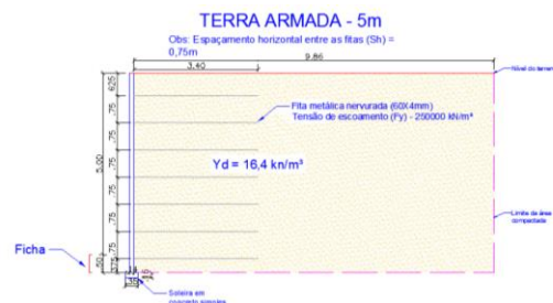
Figura 3. Corte transversal da estrutura de contenção em terra armada, 5 m.
