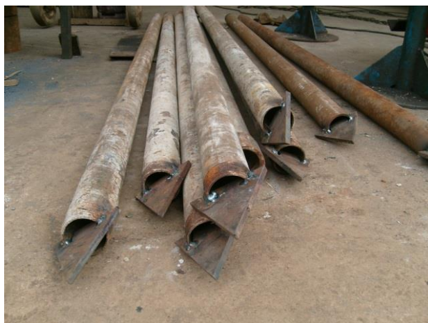
Figura 3: Detalhe da ponteira cortante com passagem para calda de cimento.
