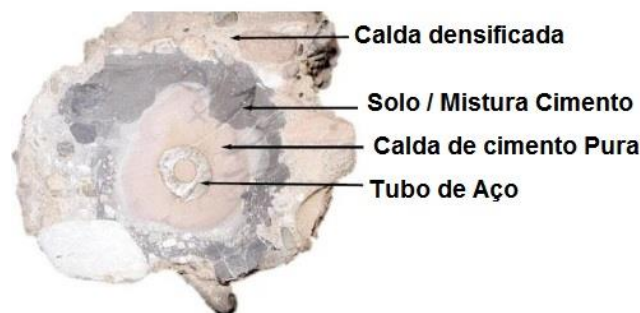
Figura 4: Seção típica de uma estaca injetada autoperfurante exumada.
