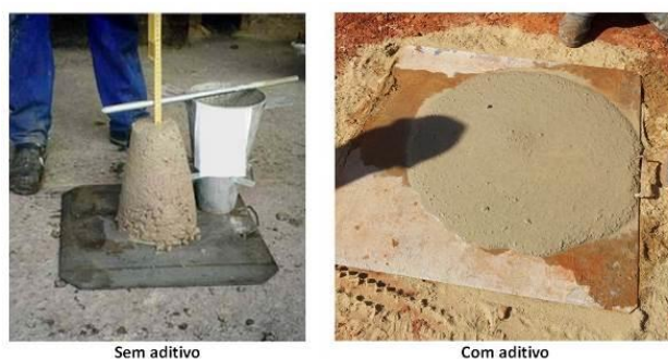
Figura 134 – Slump Test do Concreto Sem Aditivo e Com Aditivo
