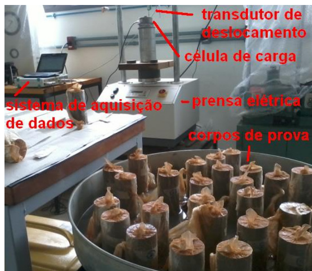
Figura 4. Arranjo experimental para ruptura dos corpos de prova em compressão simples
