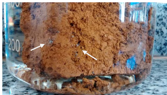
Figura 5 – Bolhas de ar aderidas à amostra de solo na umidade do solo seco ao ar por 24h ( w=23,6\% ): imersão total.
