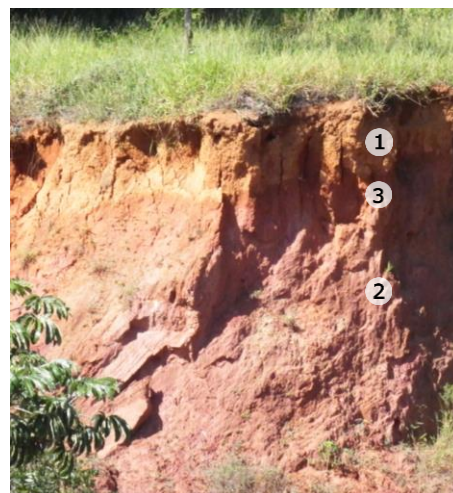
Figura 1. Perfil do solo no local de coleta, sendo 1: solo laterítico, 2: solo não laterítico e 3: zona de transição.
