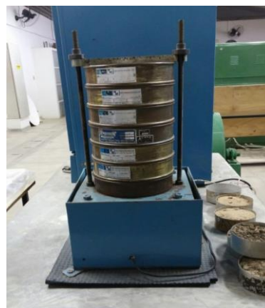
Figura 4. Sequência de peneiras usada no peneiramento grosso.
