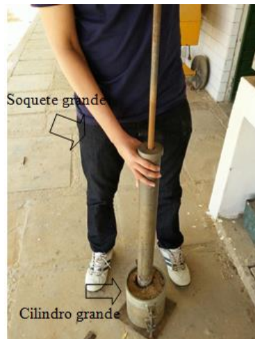
Figura 7. Soquete e cilindro usados na compactação.
