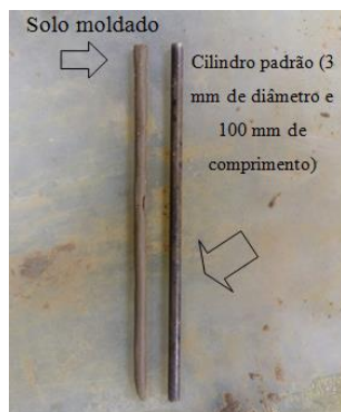
Figura 6. Detalhe do ensaio de limite de plasticidade.
