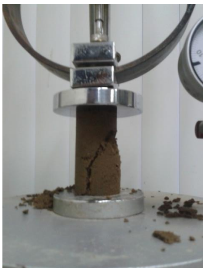
Figura 6. Exemplo de ruptura de um corpo de prova submetido ao ensaio de compressão simples.
