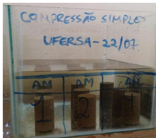
Figura 5. Inundação dos corpos de prova.
