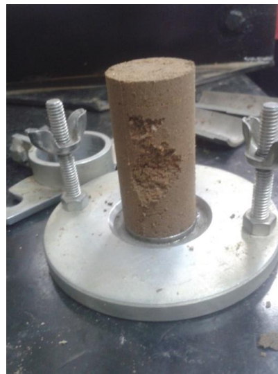
Figura 4. Redução de seção apresentado na moldagem do corpo-de-prova da amostra Solo 2.
