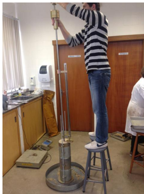
Figura 4. Realização do ensaio com o DCP.
