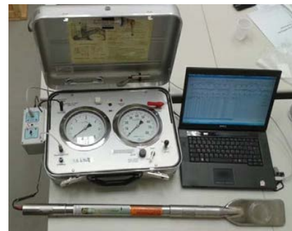
Figura 4 – Equipamento de realização de ensaio de dilatômetro com módulo sísmico da COPPE/UFRJ.
