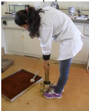
Figura 9. Corpo de prova sendo moldado sob energia de compactação normal.
