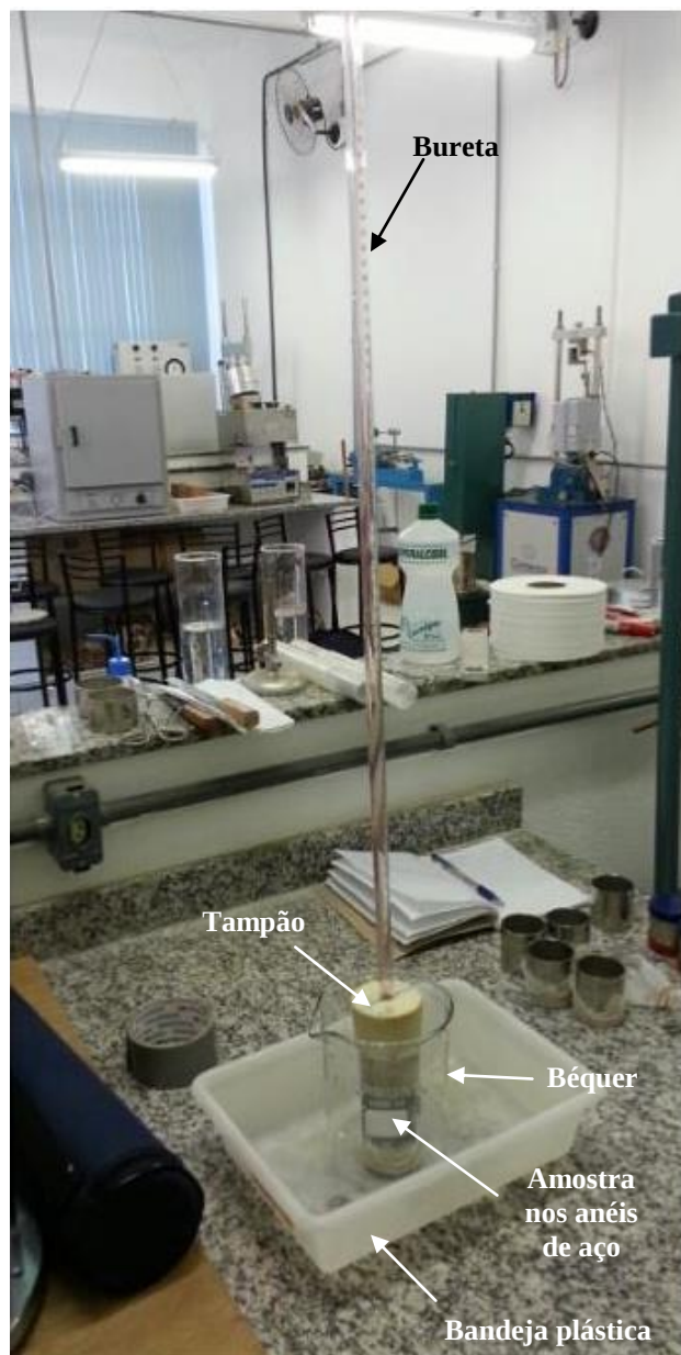
Figura 2. Montagem do ensaio de carga variável.
