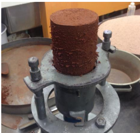
Figura 1. Moldagem dos corpos de prova.
