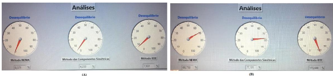
Figura 3: Índices NEMA, Componentes Simétrica (IEC) e IEEE. Sendo (A) quando equilibrado (sem vibração), e (B) quando desequilibrado (com vibração).
