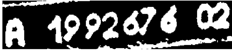
Figura 3: Binarização da imagem com aplicação dos filtros
