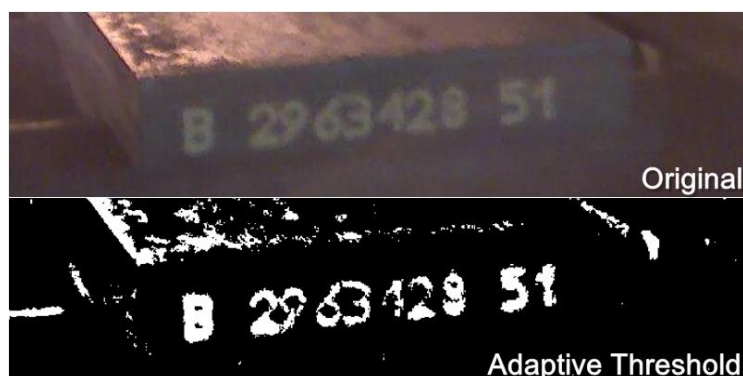
Figura 2: Imagem com iluminação ruidosa seguido da binarização feita com Adaptive Threshold
