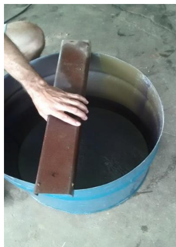
Figura 3. Encaixe de um suporte de metal na boca do tambor para apoiar a peça e a tubulação.
