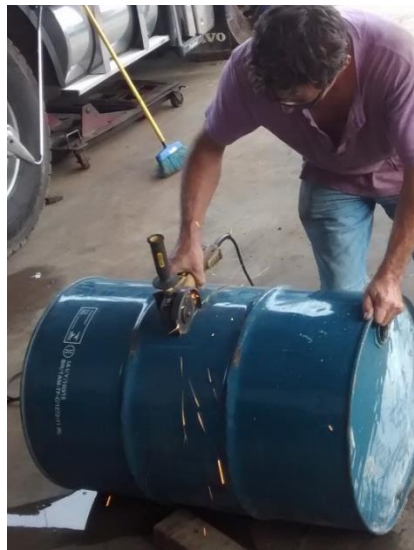
Figura 2. Corte de um tambor para conter a água
