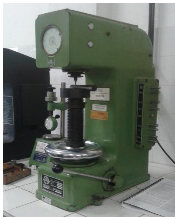
Figura 7. Dureza sendo realizada nas peças ensaiadas.
