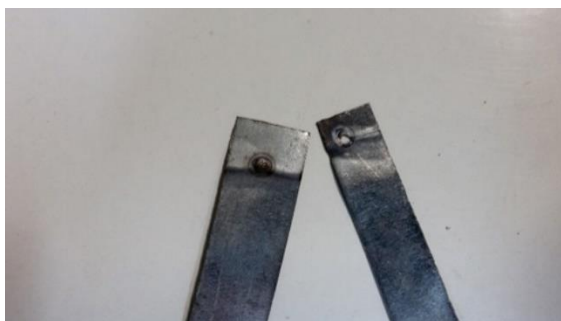
Figura 5: lente de solda após teste de ruptura.
