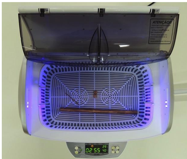
Figura 5. Limpeza das partes dos dispositivos passivos no banho ultrassônico.
