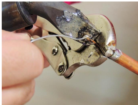
Figura 9. Soldagem do capilar do tubo de calor.
