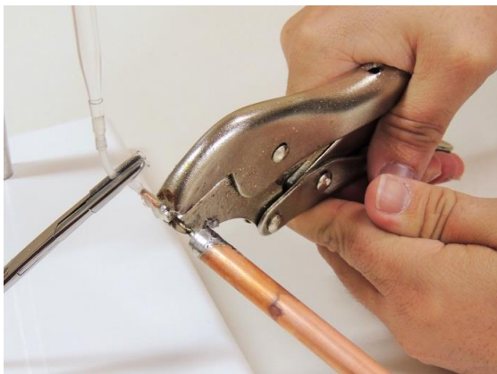
Figura 8. Clipagem do capilar do tubo de calor.
