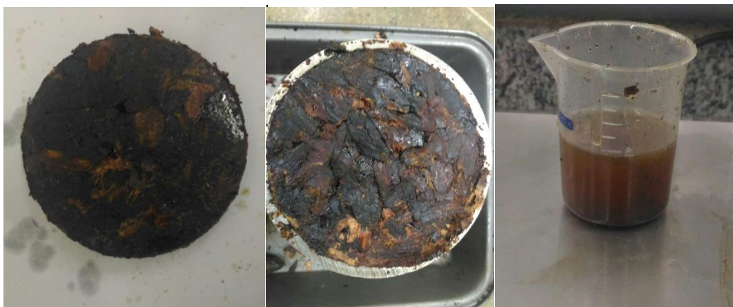
Figura 8. Torta produzida após a prensagem dos frutos da oiticica e óleo resultante.
