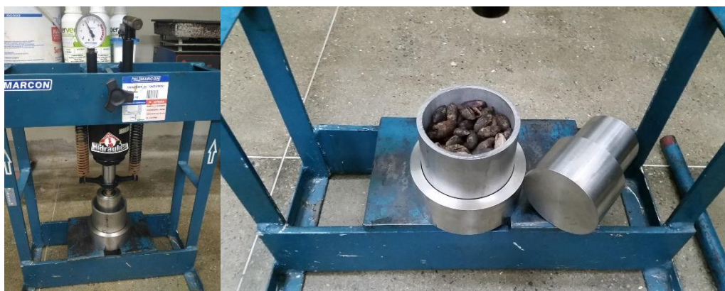
Figura 7. Prensa hidráulica e os frutos da oiticica no interior do cilindro.
