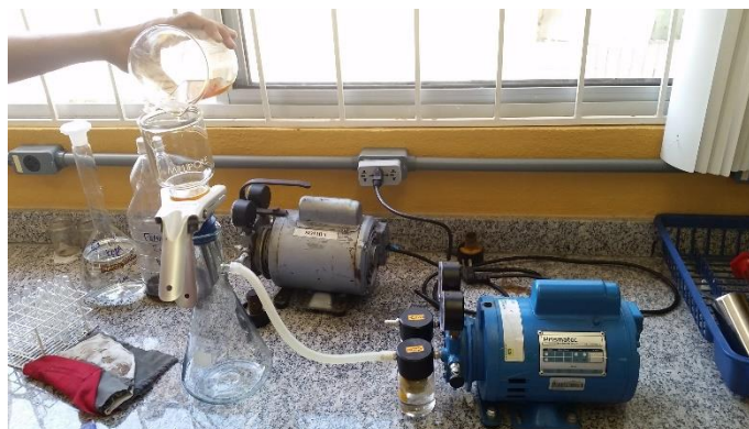
Figura 4. Filtragem do óleo.
